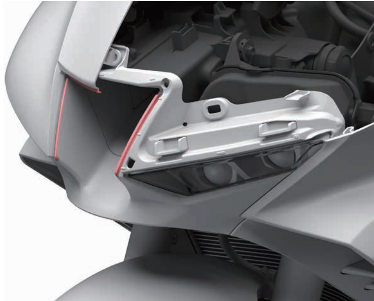
■ラムエアダクト入口タービュレーター (CGイメージ)
