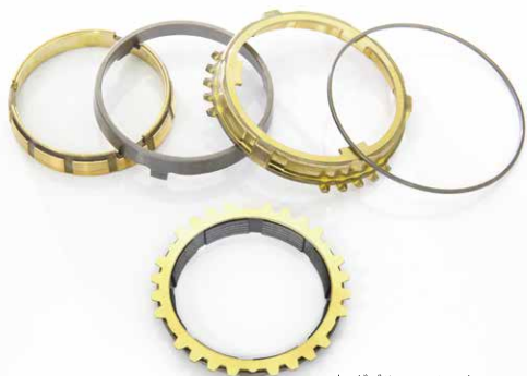
上:ダブルコーンシンクロ 下:カーボンシンクロ
