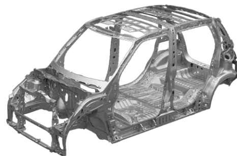
前面衝突 サブフレーム脱落構造採用/フロントフレームトラス構造採用
