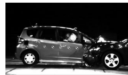
■テスト車両によるクルマ相互の衝突実験 (左 FIT)
