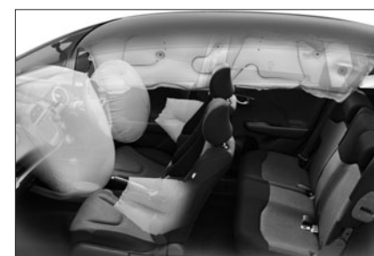
■エアバッグシステム作動イメージ 写真は機能説明のため、運転席用&助手席用SRSエアバッグシステム、前席用i-サイドエアバッグシステム、サイドカーテンエアバッグシステムともに展開した状態を合成したものです。
