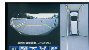
画面のボタンをタッチしてシステムを起動すると、駐車枠を自動で検出
