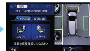
画面内のタブでバック駐車と縦列駐車切り替えができ、左右のいずれかのスタートボタンをタッチするとアシスト開始
