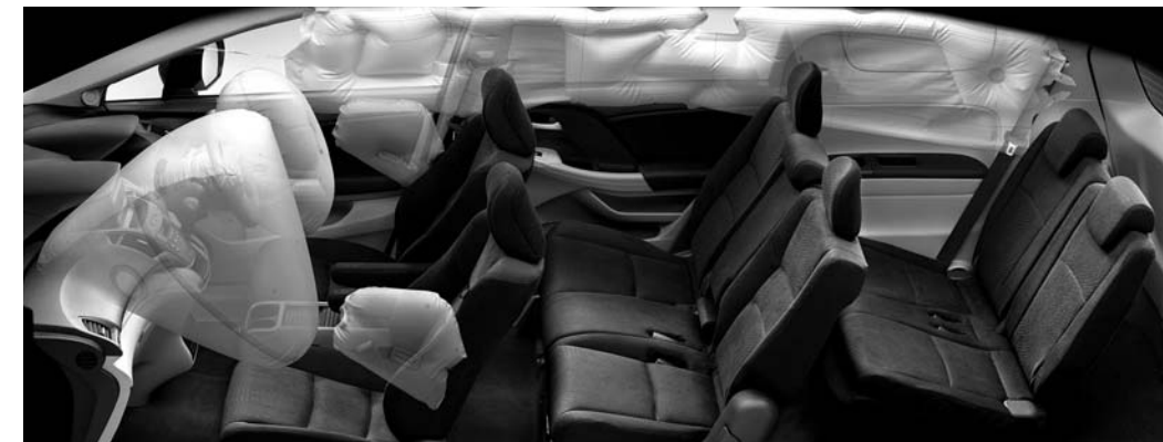
エアバッグシステム作動イメージ 写真は機能説明のため、運転席用&助手席用i-SRSエアバッグシステム、1列目シート用i-サイドエアバッグシステム、サイドカーテンエアバッグシステムともに展開した状態を合成したものです。
