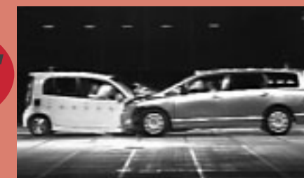
テスト車両によるクルマ相互の衝突実験 (右オデッセイ)
