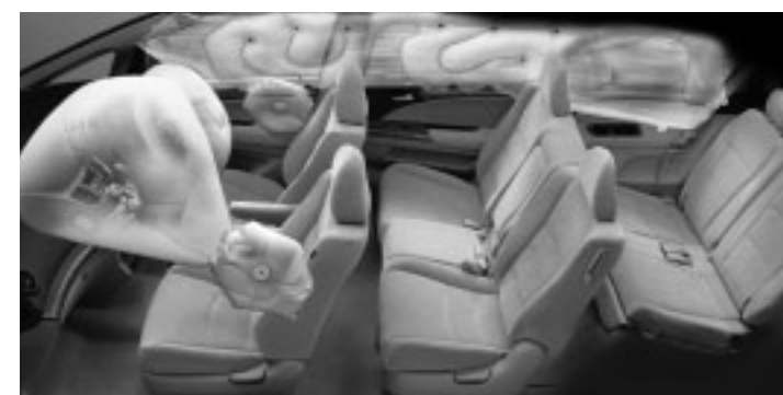
写真は機能説明のため、運転席用&助手席用i-SRSエアバッグ、1列目シート用i-サイドエアバッグ、サイドカーテンエアバッグともに展開した状態を再現し、合成したものです。
