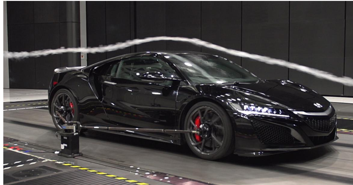
ボディ下面の空気流を走行状態で検証できるHRD Sakuraのムービングベルト式実車風洞
