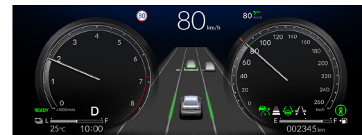
アダプティブクルーズコントロール(ACC)と車線維持支援システム(LKAS)作動時の表示例
