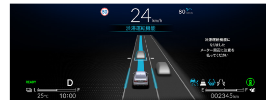
トラフィックジャムパイロット(渋滞運転機能)作動時の表示例
