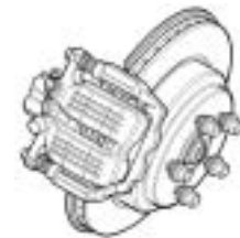
リアドラムインベンチレーテッドディスクブレーキ
