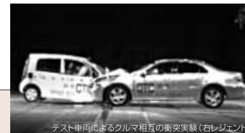
テスト車両によるクルマ相互の衝突実験(右レジェンド)
