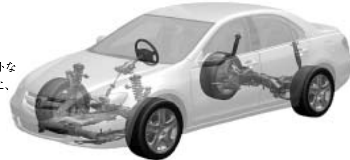
■アルミキャリパー採用ディスクブレーキ
