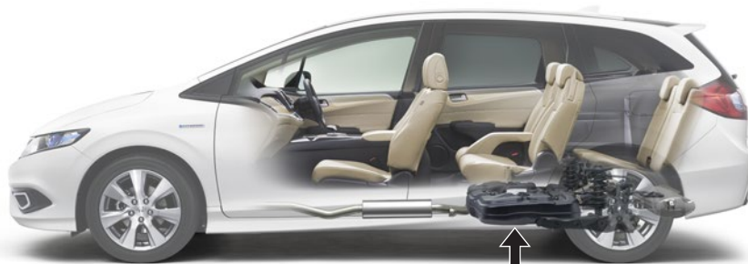
■2ベントシステム採用超薄型フューエルタンク
