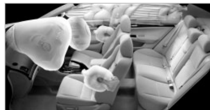
写真は機能説明のため、運転席用&助手席用エアバッグ、前席用i-サイドエアバッグ、サイドカーテンエアバッグともに展開した状態を再現し、合成したものです。
