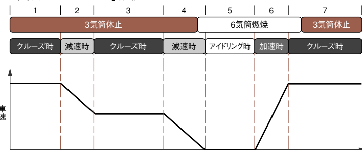
■「可変シリンダーシステム」作動イメージ
