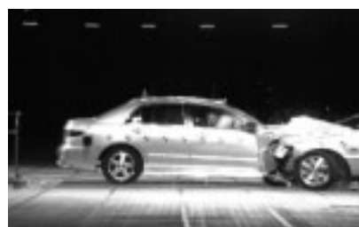
テスト車両によるクルマ相互の衝突実験 左インスパイア
