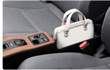
センターコンソールに仕切板を差し替えてスペースを調整できるトレイを配置。高さを抑えサイドウォークスルーのしやすさを追求。
