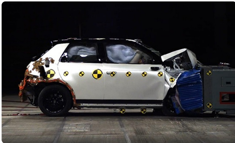
オフセット64km/h前面衝突試験
