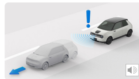
停車時に、先行車が発進したことをお知らせ 先行車発進お知らせ機能
