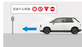
標識の見落とし防止を図り、安全運転を支援 標識認識機能
