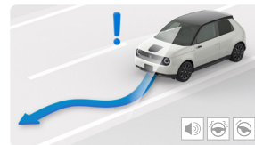
車線を検知し、はみ出さないように支援 路外逸脱抑制機能
