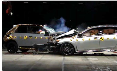
Car to Car衝突試験 50km/h (Honda独自基準)
