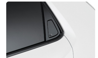
後席のアウターハンドルは、ノイズの少ないデザインを重視し、きわめて小型のフラップタイプにしています。
