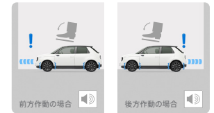
壁などの障害物の見落としによる衝突回避・被害の軽減を支援 近距離衝突軽減ブレーキ*
