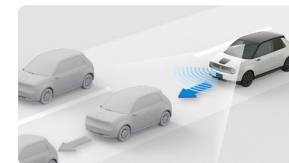
適切な車間距離を保ち、運転負荷を軽減 渋滞追従機能付 アダプティブクルーズコントロール(ACC)
