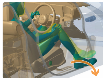
ステップ部分にほとんど段差が少ない掃き出し構造で楽に乗り降りでき、よりシームレスな乗降が可能に。
