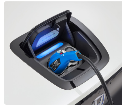
LEDライトは、充電中は青色で点滅し、充電が終了すると消灯。
