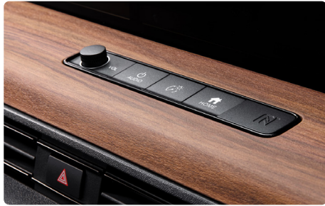
水平基調のウッド調パネルの上に、シンプルにデザインしたスイッチ類とNFCセンサーを配置。
