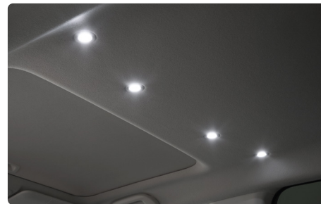
リビングらしさの演出として、ルームライトはダウンライトのLEDを4つ配置。
