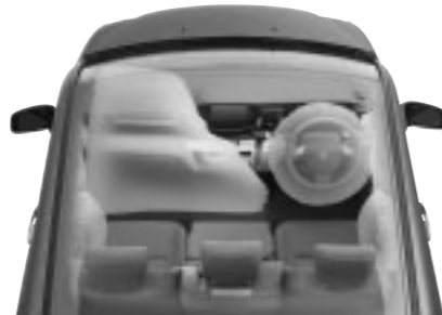
写真は機能説明のため、運転席用&助手席/前中央席用SRSエアバッグシステム、前席用i-サイドエアバッグシステム、サイドカーテンエアバッグシステムともに展開した状態を合成したエアバッグシステム作動イメージです。
