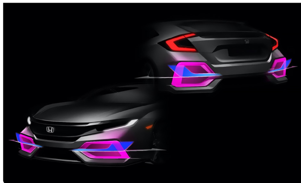
前後ランプのL字形の造形とシンクロさせることをイメージした、ロアガーニッシュのデザインスケッチ。
