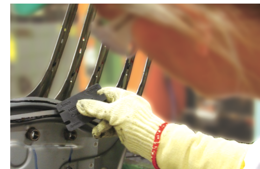
トレーニングを受けた専任スタッフが塗布するとともに、接着剤の厚みや幅、長さなどを厳密に管理
