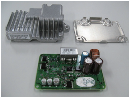
Fig. 10 Booster ACM ECU
