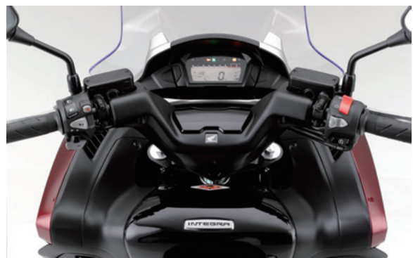
Fig. 16 Meter display unit of INTEGRA
