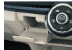
Fig. 13 Lid type center pocket
