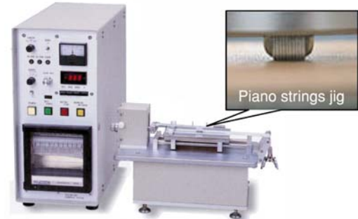
Fig.2 Friction tester KES-SE (KATO TECH CO.,LTD)
