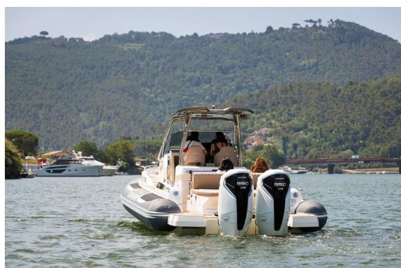
新型大型船外機 BF350 搭載例
