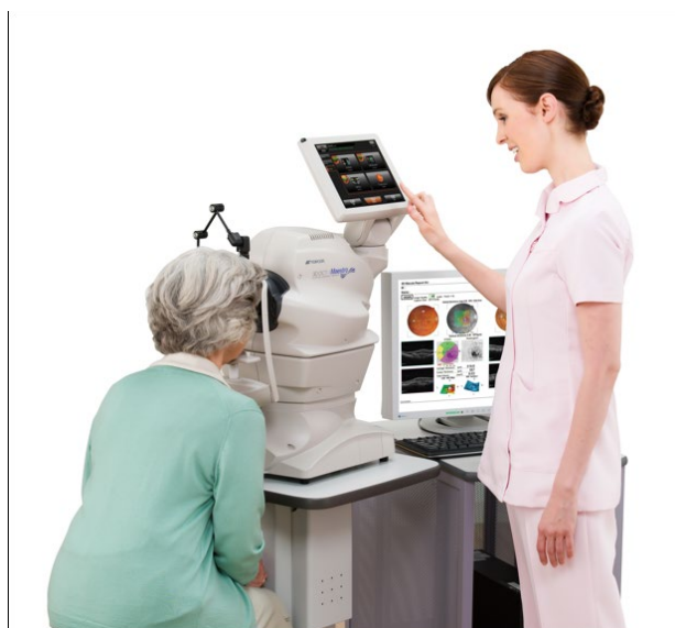
眼底カメラが一体型となった最新型 OCT 装置 現在、OCT は眼科における標準的な画像診断手法となっている
