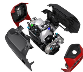
高い剛性・軽量化を実現する モノコック構造
