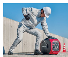
始動時の 2 ステップ (スイッチオン、リコイル操作)
