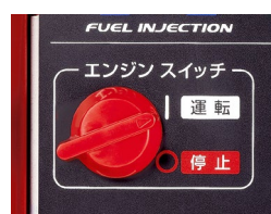
始動時の 2 ステップ (スイッチオン、リコイル操作)
