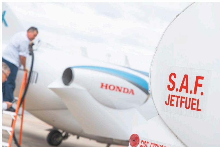
SAF は航空領域での CO<sub>2</sub> 排出量を削減し、カーボンニュートラルを達成する手段の 1 つとして注目されています。SAF の利用は ASTM International による認可制となっており、既存のジェット燃料へ SAF を混合できる含有率の上限が定められています。現在の上限は 50% となっていますが、今回の試験により、今後の SAF の進化・普及に向けて、100% SAF を使用できる可能性を確認することができました。
