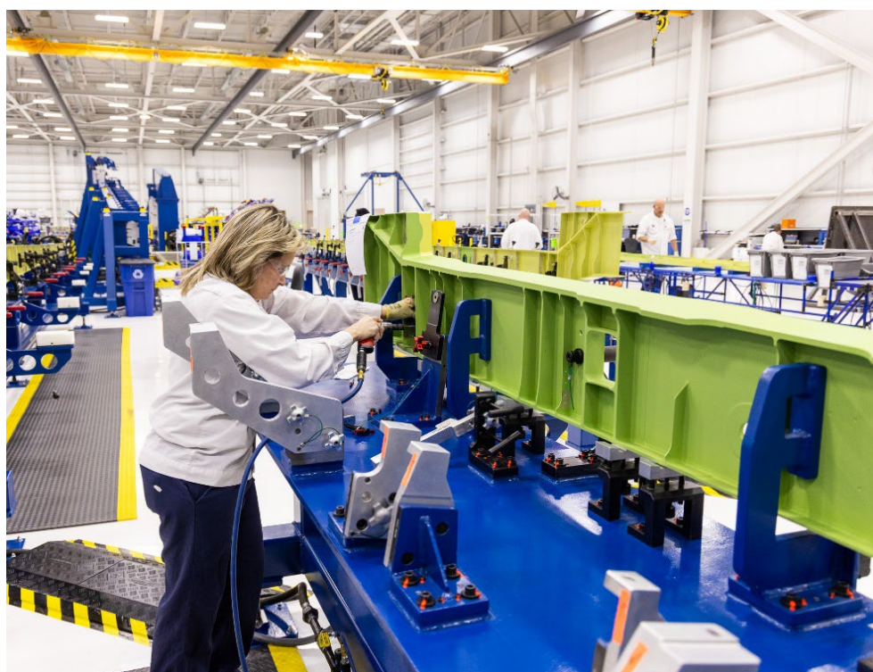
組み立てが開始された主翼部分
