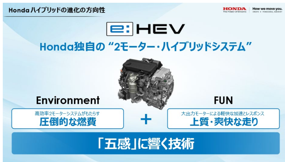
Honda 独自の2 モーターハイブリッドシステム「e:HEV」
