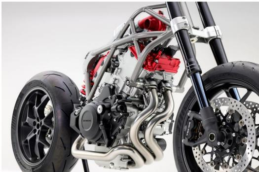
電動過給機付き V 型 3 気筒エンジン
