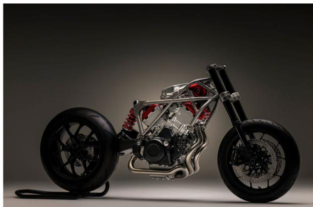
電動過給機付き V 型 3 気筒エンジン（コンセプトモデル）
