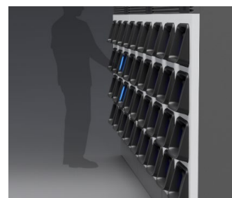
LED 表示により交換動作を誘導 左右方向からも見やすい表示
