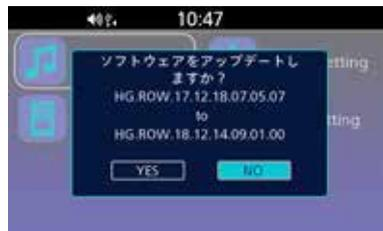
※更新作業終了後、現在時刻を必ずUTC+9:00に設定してください。 ※Bluetooth®ヘッドセット/電話のペアリングを再度行ってください。
